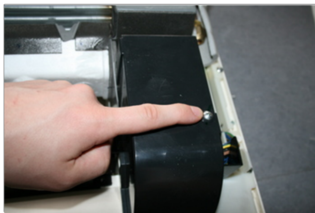
16 Открутите винт крышки клеммной колодки.
