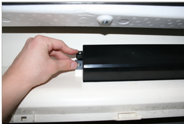
13 Открутите винты крышки платы управления слева.
