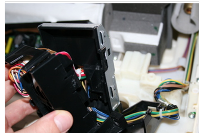
20 Отделите основание от клеммной колодки.
