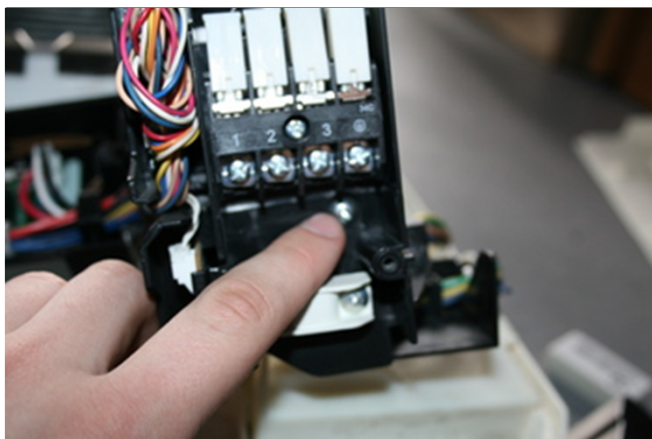
18 Открутите винт крепления основания клеммной колодки.
