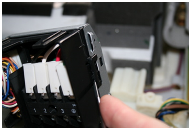
19 Подденьте основание клеммной колодки.
