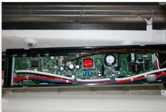
22 Подключите один конец кабеля к разъему платы управления S21 внутреннего блока.
