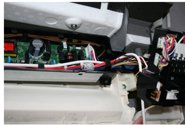
23 Проложите кабель во внутреннем пространстве блока.
