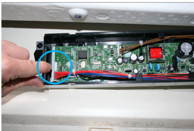
15 Снимите крышку платы управления. Разъем подключения S21 указан на картинке.
