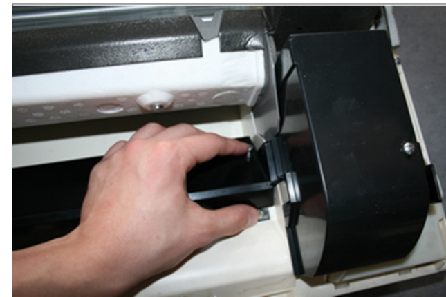
14 Открутите винты крышки платы управления справа.
